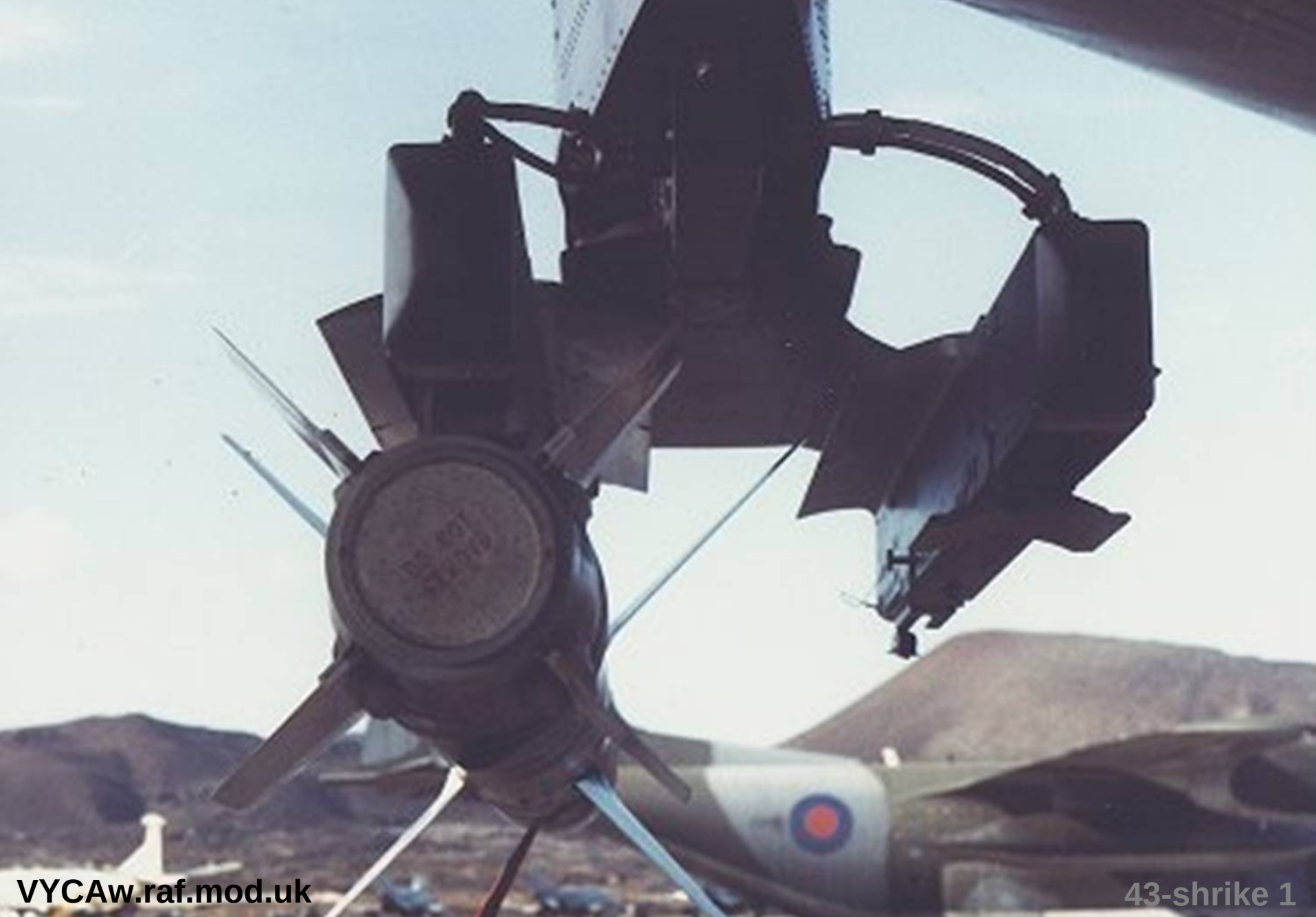
En la estación de ala izquierda del Vulcan han colocado un pilón que puede llevar dos misiles antirradiación Shrike . En la foto, tomada en Ascensión, se ve uno de los misiles ya instalado.
