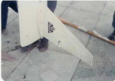
Daño de proyectil ingles sobre la antena de VHF
